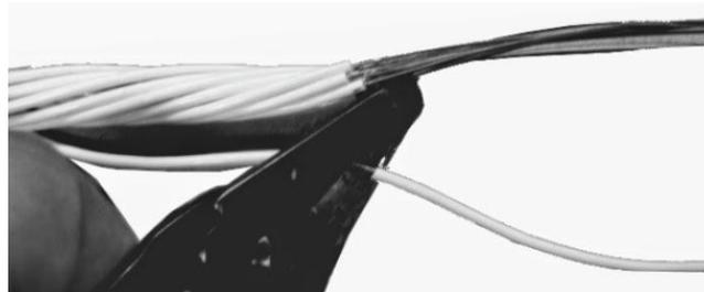
Usando o roletador ou outra ferramenta adequada, retire neste ponto o tubo loose, deixando as fibras expostas.
