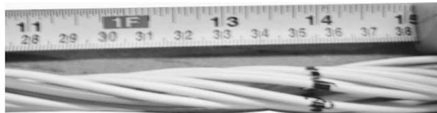
Detalhe da medida para cortar os tubos loose
